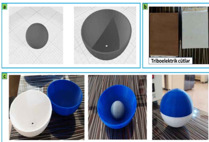
Şəkil 1. a) topların sxematik təsviri, b) triboelektrik cütlər, c) 3D printerdə çap olunmuş toplar
