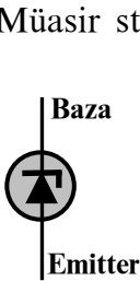
Şəkil 4.1.6. Stabilitronun sxemlərdə qrafiki təsviri
